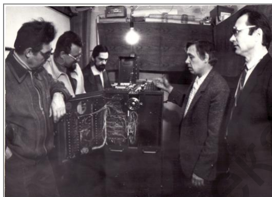
Группа кинолюбителей из разных регионов России знакомятся с проявочной машиной. Автором технической идеи и её конструктором является А. С. Гриненко (1986 г.)
